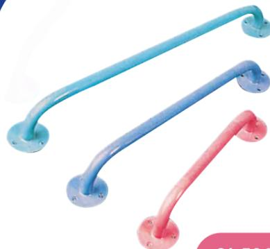
+ Barre d'appui en acier, finition époxy. Adaptée pour la salle de bain ou les toilettes. Tube acier Ø 25 x 1.2 mm. Platine de fixation acier diam. 80 mm Epaisseur 3 mm. Assemblage par brasage OA.
